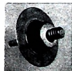
Mesa-Transistor TV 44 von Siemens in koaxialen Metallgehäuse (Flansch-Ø etwa 10 mm)
